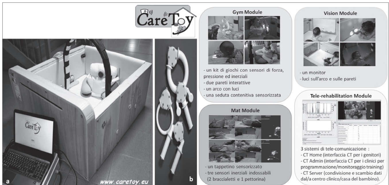
Fig. 1. a: Sistema CareToy, b: kit di 4 giochi sensorizzati. Il sistema è costituito da 4 moduli: modulo Gym per l'esercizio posturo-motorio e della funzione manuale; modulo Vision per la stimolazione della funzione visiva; modulo Mat per l'acquisizione dei dati sul movimento del bambino durante il training; modulo Tele-riabilitazione che consente i) l'uso del sistema da casa, ii) la programmazione del training dal centro clinico, iii) la comunicazione del sistema da/a centro clinico a/da casa del bambino.
